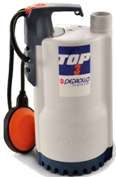
La bomba de serie TOP es adecuada para el drenaje de **aguas claras** sin partículas abrasivas. Las soluciones constructivas empleadas garantizan la facilidad de uso y la seguridad de funcionamiento gracias a la refrigeración total del motor y el doble sello en el eje.
